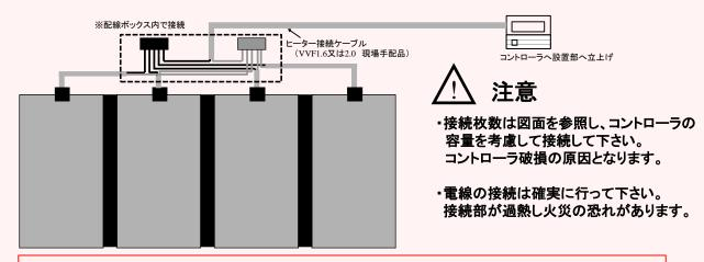
電線長さが3mあります。配線ボックスで出来る限り一連で結線しコントローラへ接続下さい。
