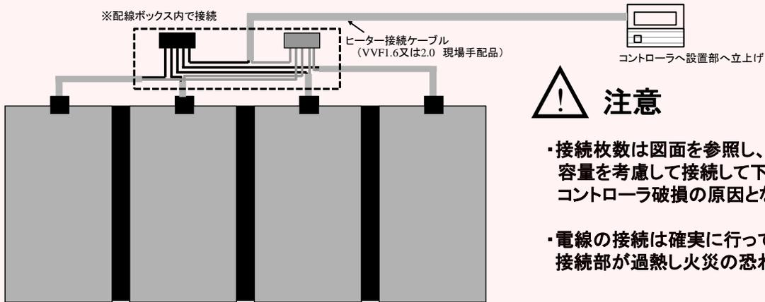
電線長さが3mあります。配線ボックスで出来る限り一連で結線しコントローラへ接続下さい。
